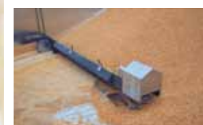
Vybírací šnek Lety prověřená konstrukce pro mechanizované vybírání zbytkového materiálu.
