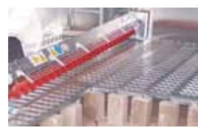
Celorošťová provětrávaná podlaha Zajišťuje perfektní podmínky pro provětrávání. Podlaha je vyrobena z galvanicky pozinkovaných tvářených plechů a umístěna na betonových bločcích. Perforace podlahy v řepkovém provedení.
